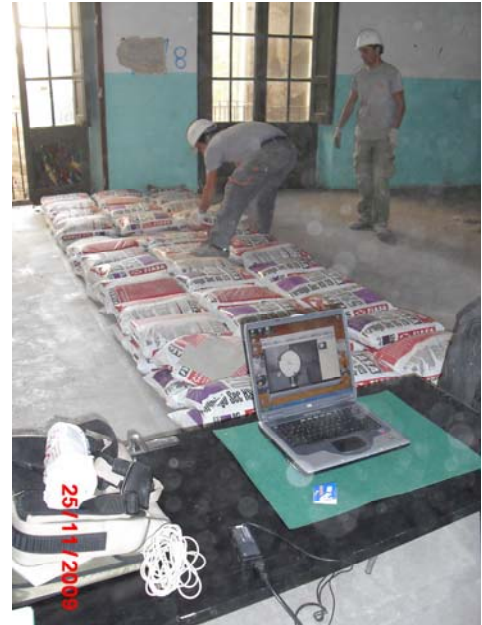
Monitorització i càrrega d'una prova en sostre en obra a Manresa amb Ramón Bacardit, arquitecte
