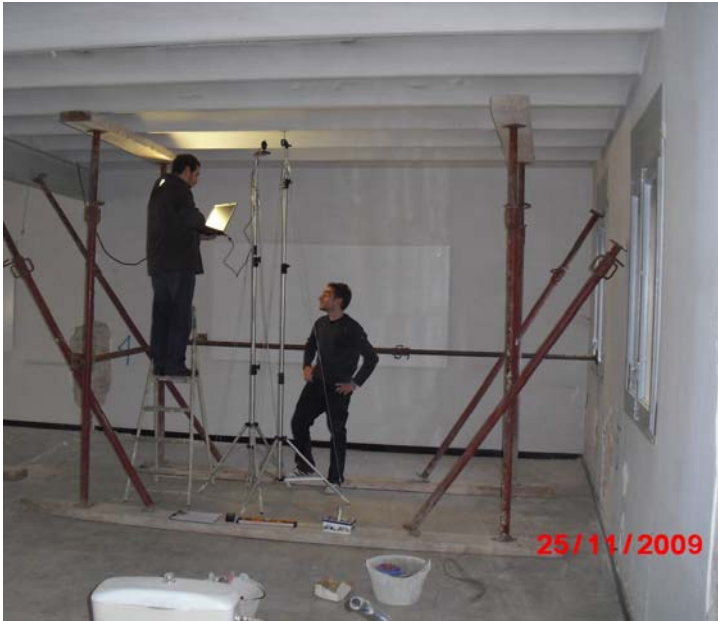
Monitorització i càrrega d'una prova en sostre en obra a Manresa amb Ramón Bacardit, arquitecte
